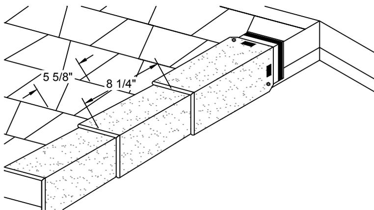
RAKE EDGE INSTALLATION: EZ-RIDGE SHINGLES CAN ALSO BE INSTALLED ON RAKE EDGES. INSTALL RAKE EDGE SHINGLES BEFORE RIDGE SHINGLES.
