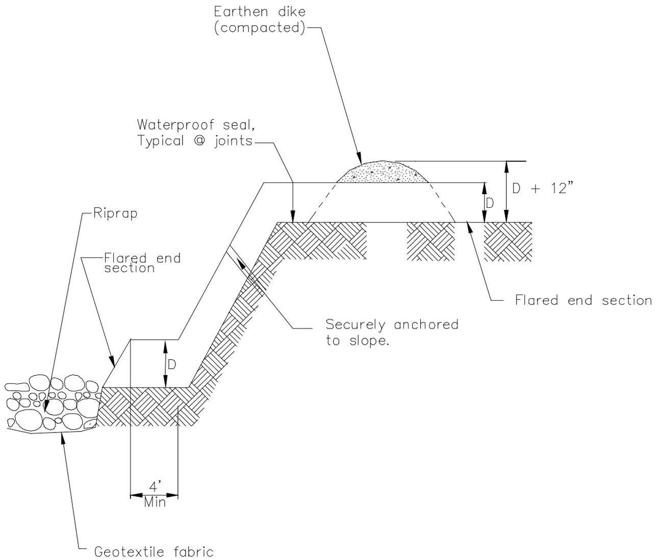
TYPICAL SLOPE DRAIN
